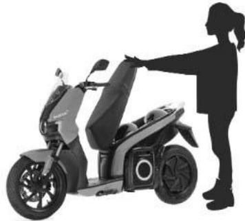
**1** Öffnen Sie den Sitz mit der App, dem Schlüssel oder indem Sie gleichzeitig beide Bremshebel betätigen.
