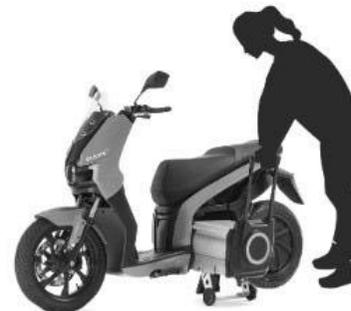
**7** Transportieren Sie den PBP und setzen Sie ihn in den Roller ein.
