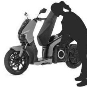
**3** Entfernen Sie den Power Battery Pack mit eingezogenem Griff, indem Sie ihn nach außen ziehen.
